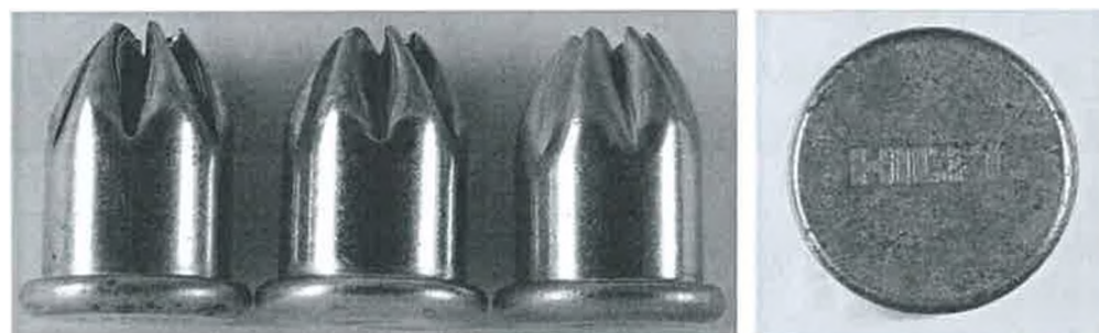
圖七 黑色、紅色和黃色口部封漆之空包彈(左)及三種空包彈之彈底標記(右)
