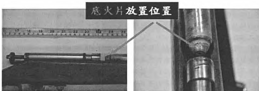
圖一 打擊底火前膛槍之槍管後端構造
