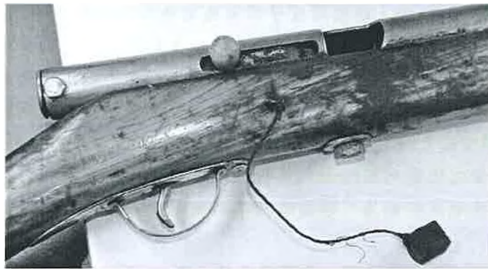
圖五 原住民自製獵槍之粗略保險裝置
